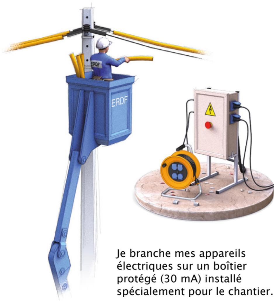
Je branche mes appareils électriques sur un boîtier protégé (30 mA) installé spécialement pour le chantier.
