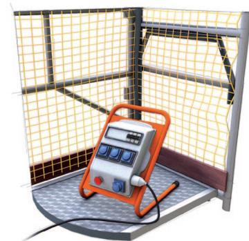
Je branche mes appareils électroportatifs sur un boîtier protégé (30 mA) installé spécialement pour le chantier.
