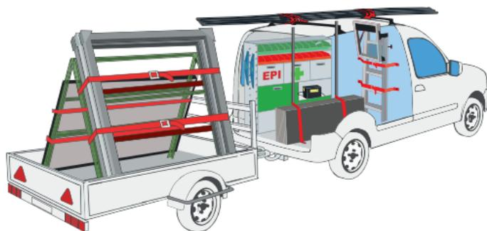
Pour limiter les risques, divisez l'ouvrage en plusieurs sous-éléments lorsque cela est possible. A défaut, utilisez les galeries latérales, les pupitres ou encore les barres télescopiques pour les arrimages intérieurs.
