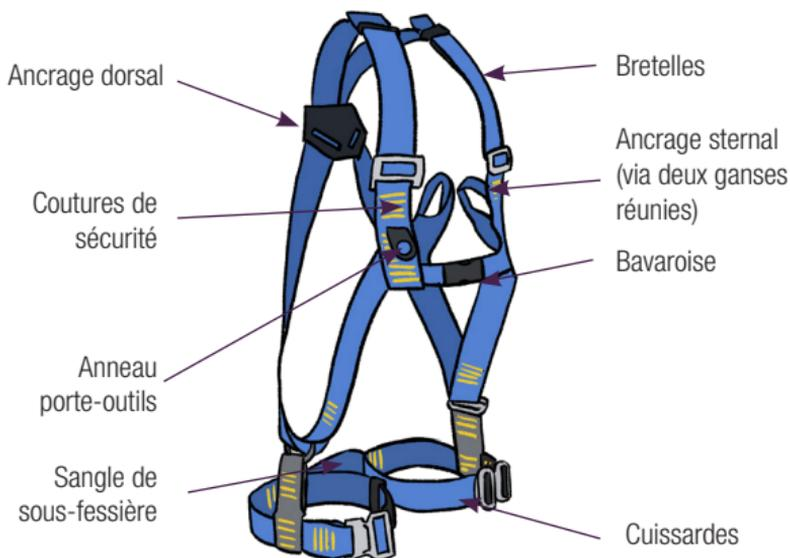
Le harnais doit être adapté à la morphologie de son utilisateur et garantir un confort au poste de travail
